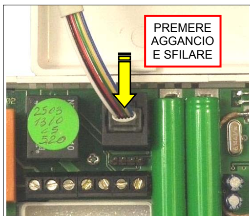
Fig. 3 - Estrazione connettore display
